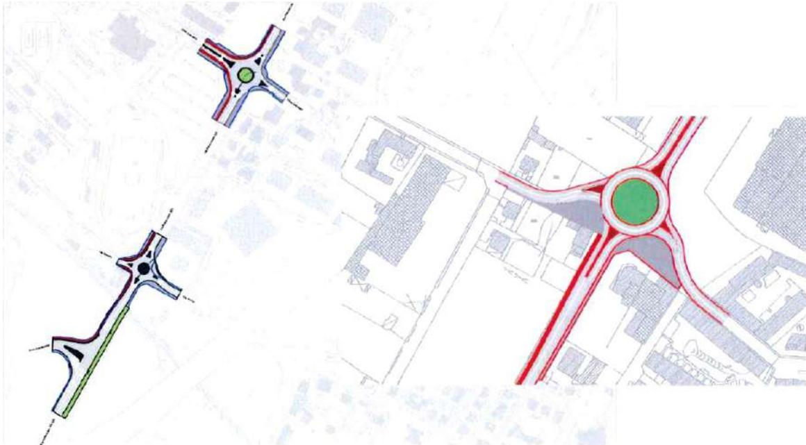
Figura. Rappresentazione delle ipotesi progettuali di rotonde in corrispondenza degli incroci di Via Guzzanica, Via Locatelli e Via Roma
